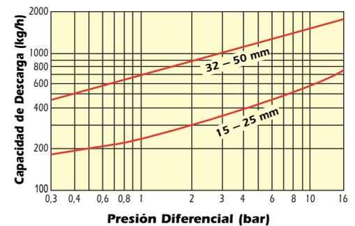
1. La presión diferencial es la diferencia entre la presión de entrada y la presión de salida de la trampa.
