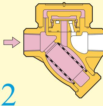
Cuando aumenta la temperatura dentro de la trampa, el bimetálico se expande y libera el disco. Simultáneamente, el área de baja presión creada por el condensado flasheando/vapor fluyendo debajo del disco, más una alta presión en la cámara de presión en la parte superior del mismo, fuerzan al disco hacia abajo. Una chaqueta de vapor aísla la cámara de presión de la pérdida de calor por radiación que podría causar actuación sin carga.
