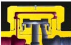
En trampas con tapa simple, las condiciones atmosféricas adversas y las pérdidas de calor por radiación resultan en fugas y pérdida de vapor por actuación sin carga. Aunque este problema se resuelve parcialmente con una chaqueta de aire, la chaqueta de la A3N calentada con vapor y enfriada por condensado ofrece la mayor protección, asegurando la operación más estable comparada con todas las trampas de vapor termodinámicas.
