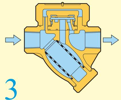
Eventualmente, la cámara de presión se enfría cuando el condensado entra a la chaqueta superior, disminuyendo la presión de la cámara y permitiendo que la presión de entrada empuje el disco hacia arriba y descargue el condensado. Al entrar condensado flasheando/vapor cierra la trampa, como en el paso 2.
