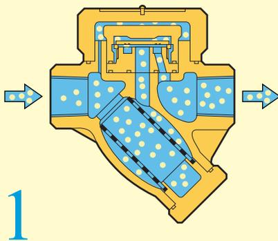
Durante la puesta en marcha, el anillo bimetálico está contraído, levantando el disco del asiento y permitiendo la rápida descarga de aire y condensado frío.
